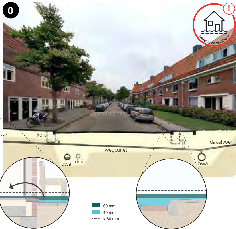
De details tonen de waterhoogten van 40mm, 60mm en meer dan 60mm in een uur
