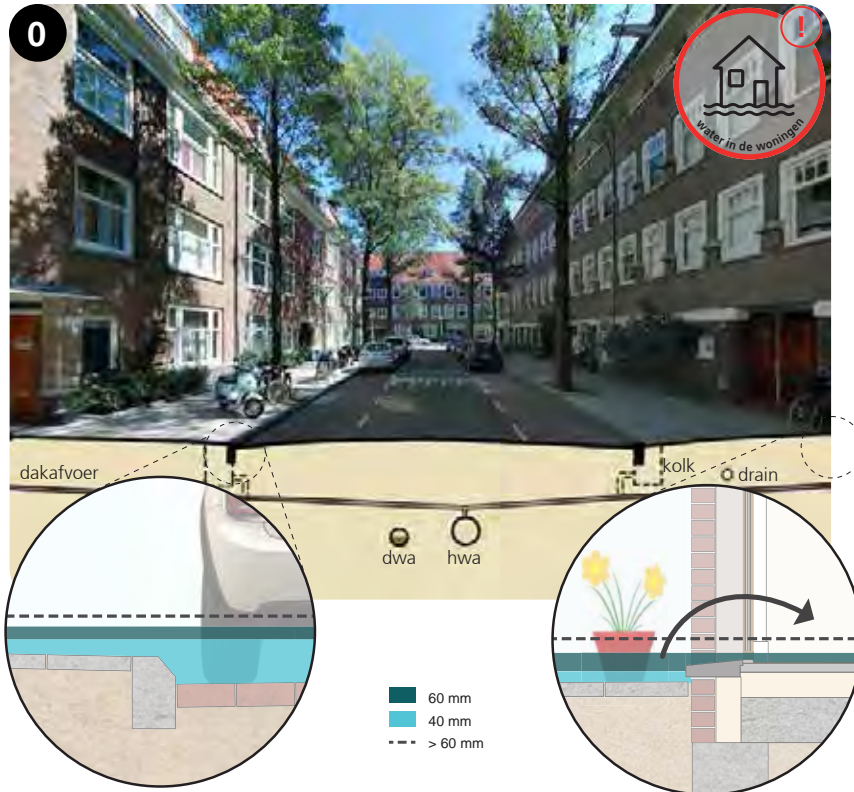
De details tonen de waterhoogten van 40mm, 60mm en meer dan 60mm in een uur
