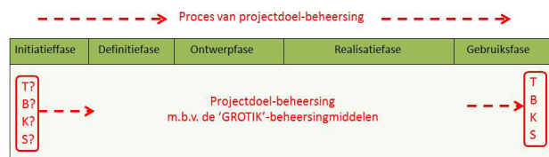
Figuur 2-9 Sturing op doelen (TBKS) m.b.v. GROTIK ('heb ik de beheersaspecten om mijn doel te kunnen bereiken op orde?').
